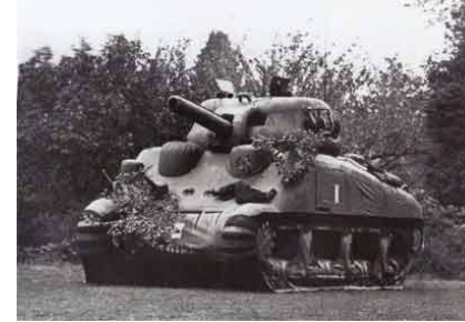
Faux char en caoutchouc. Vu d'avion il était impossible de les distinguer des vrais.
